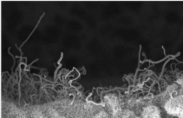
تصویر SEM از نانولوله‌های کربنی چنددیواره رشد یافته روی سطح تیتانیوم
