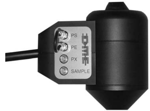
شکل ۶- نمونه‌ای از روبشگر؛ پروب (کانتی‌لیور) در انتهای پایینی آن نصب می‌شود.
