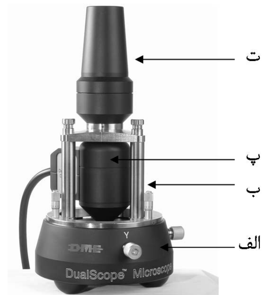
شکل ۷- نمونه‌ای از مجموعه (الف) میز X, Y ، (ب) سه‌پایه نگهدارنده، (پ) روبشگر و (ت) دوربین CCD.
