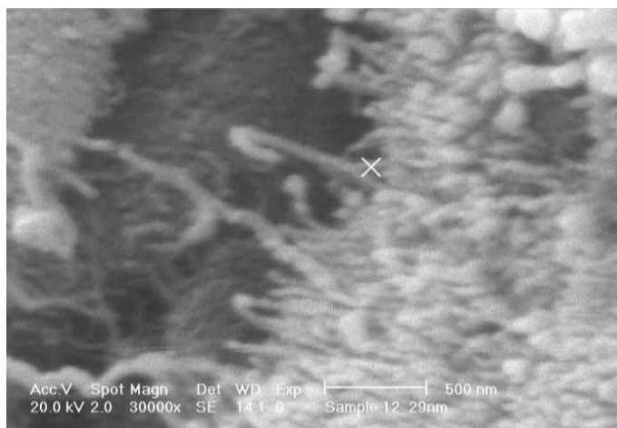
شکل ۳- تصویر SEM پس از فعال‌سازی نانولوله‌های کربنی و جدا کردن پودر بدون استفاده از سانتریفوژ
